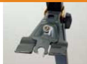
Ausreißer: Befestigungselement des Grundträgers für den Golf IV vor und nach dem Crash mit 30 km/h.
