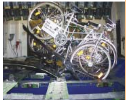
Im freien Fall: Auf dem Prüfschlitten im Labor versagten die Grundträger beim Crash.
